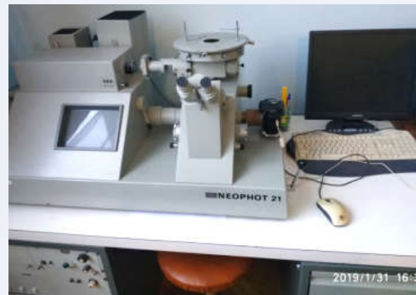
Оптичний мікроскоп Neophot-21
