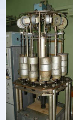
Установка для випроб на тривалу міцність (сповільнене руйнування)
