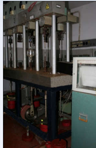
Установки для випробувань зразків на опір корозійному розтріскуванню
