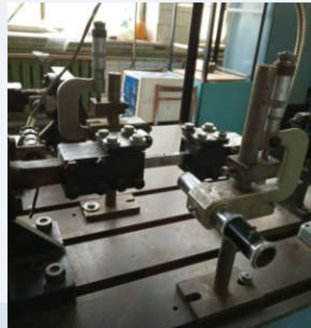
Установка для випробовування призматичних зразків за чистого згину в умовах циклічного навантаження і впливу корозивних середовищ
