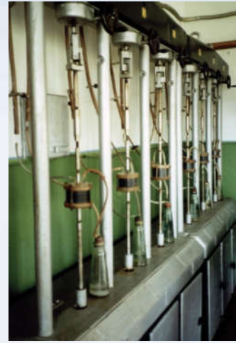
Установки для випробувань зразків на опір корозійному розтріскуванню
