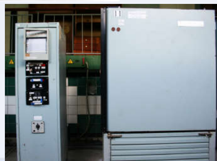
Камера тепла та вологи 12 КТВ
