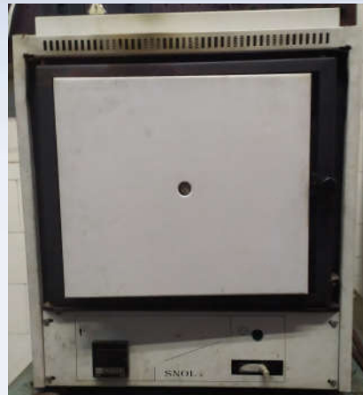
Печі для термічної обробки металів: СНОЛ 6,7/1300; СНОЛ 1,6.2,5,1/9-ИЗ та СНОЛ 0,35
