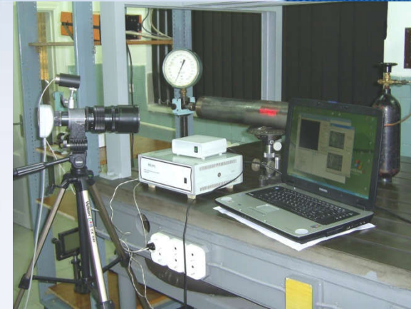
Переносний оптико-цифровий спекл-корелятор у складі експериментальної установки для дослідження пружно-пластичних деформацій біля концентраторів напружень в трубчастих елементах конструкції
