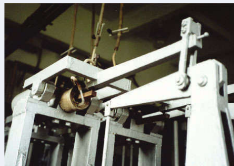
Установка ДП-1 для дослідження тріщиностійкості матеріалів
