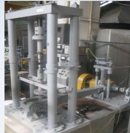
Установка для втомних випроб за умов циклічного розтягу
