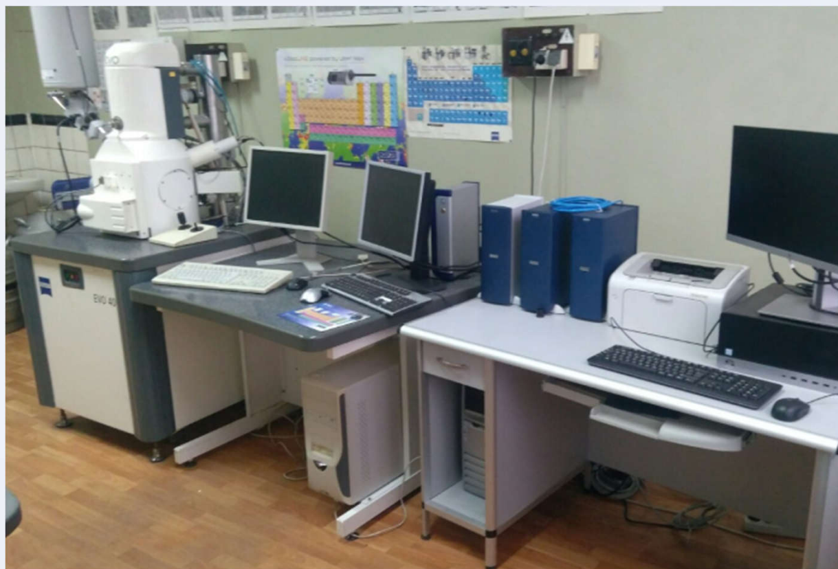
Сканівний електронний мікроскоп Zeiss EVO 40XVP із EDX- та EBSD-системами (Oxford Instruments)
