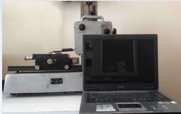
Профілометри моделей «Калибр С-265» та 170621
