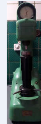
Прилади ТБ-2109 та ТК-2 для виміру твердості методом Брінелля та Роквелла.
