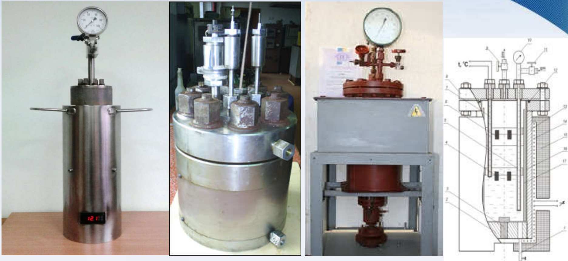
Автоклави для корозійних та корозійно-механічних досліджень у агресивних середовищах ( t = 25 \dots 150^\circ\text{C} ; P = 0,1 \dots 10 \text{ МПа} )
