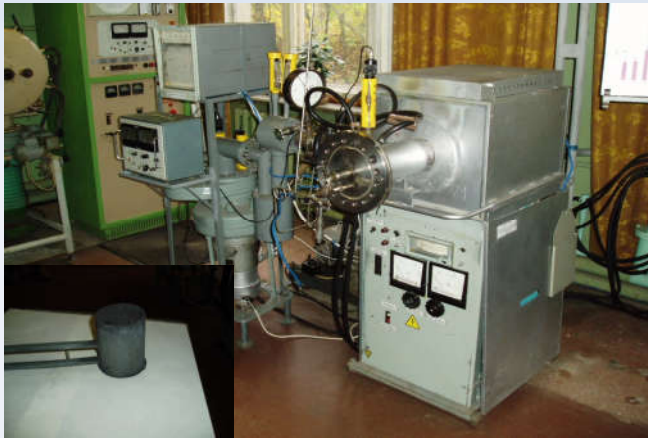
Установка для термодифузійного борування
