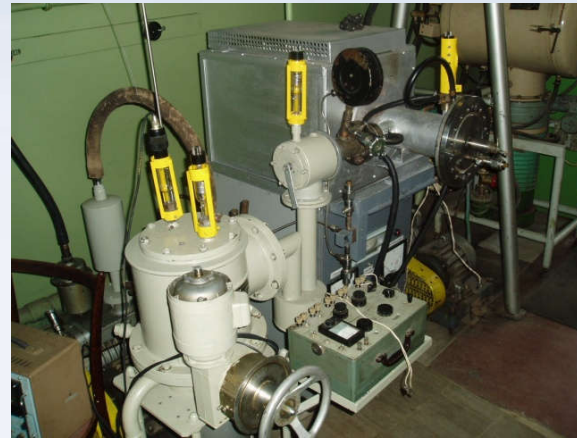
Установки для термодифузійного насичення з порошків у вакуумі та контрольованих газових середовищах
