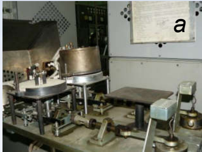
Установки для випроб на малоцикловий чистий згин в широкому температурному діапазоні: 20...600°C (а) та -196...20°C (б) та на втому за циклічного розтягу з асиметричним циклом (в).
