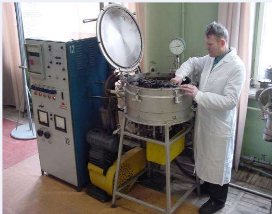
Машина для випроб на малоцикловий чистий згин у вакуумі та газових середовищах (Ar, He, N 2 ).
