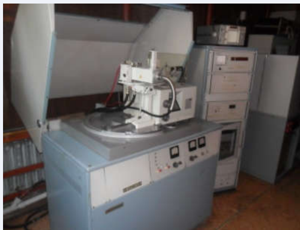
Дифрактометр рентгенівський ДРОН 3.0
