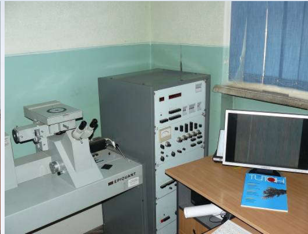
Оптичний мікроскоп "Epiquant" для кількісного та якісного фазового аналізу
