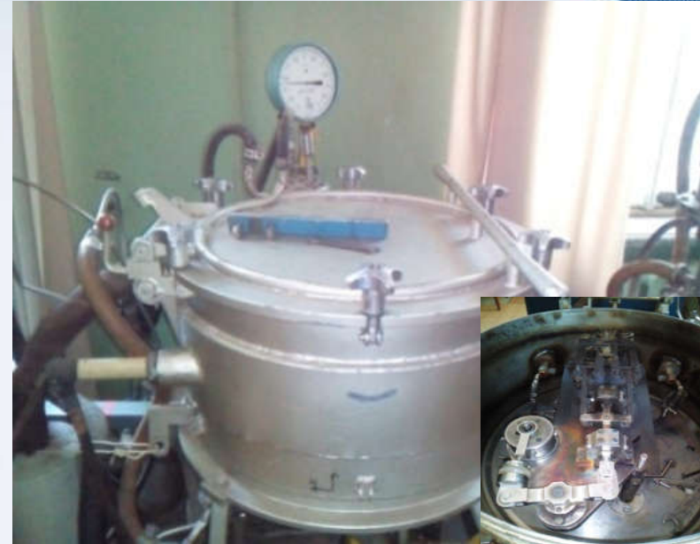
Установка для випробувань матеріалів чистим згином УМДУ-01 у рідкометалевих середовищах
