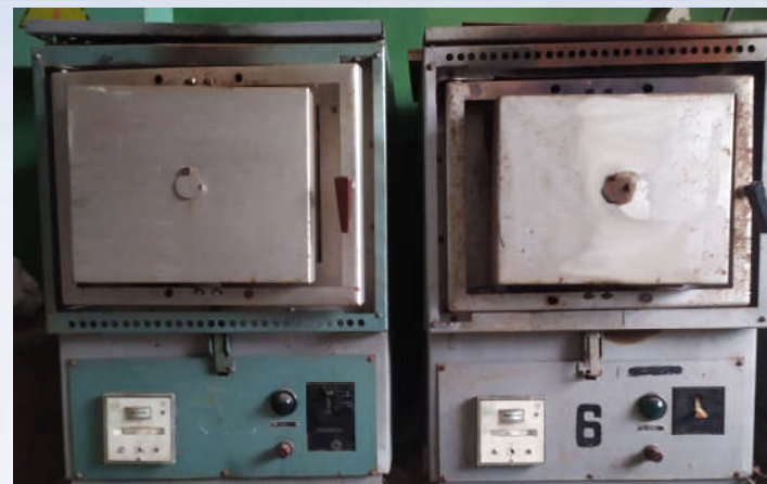
Печі для термічної обробки металів: СНОЛ 6,7/1300; СНОЛ 1,6.2,5,1/9-ИЗ та СНОЛ 0,35
