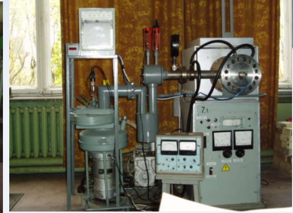
Установки для термодифузійного насичення з порошків у вакуумі та контрольованих газових середовищах
