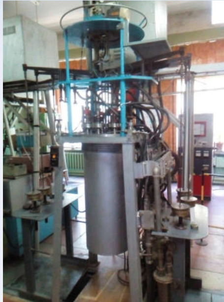
Шестипозиційні установки для випробувань на тривалу та короточасну міцність
