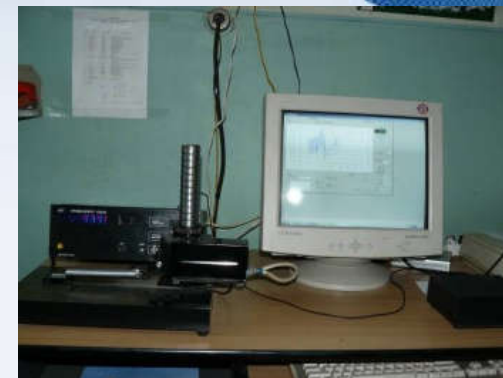
Профілометри моделей «Калибр С-265» та 170621
