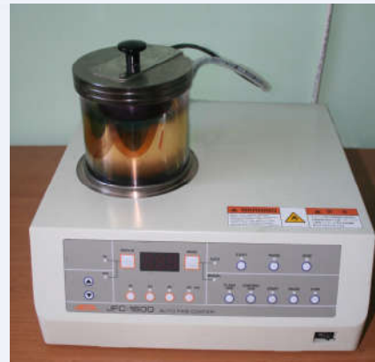
Jeol JFC-1600 установка для напилювання зразків магнетронного типу
