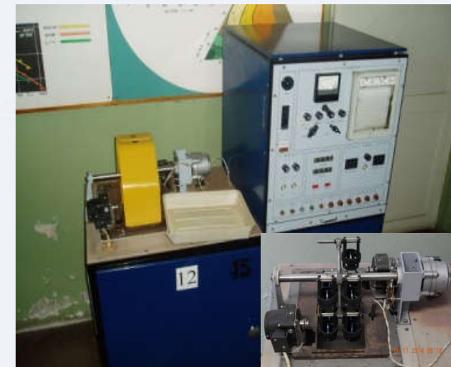
Установка для корозивних випробувань методом періодичного змочування
