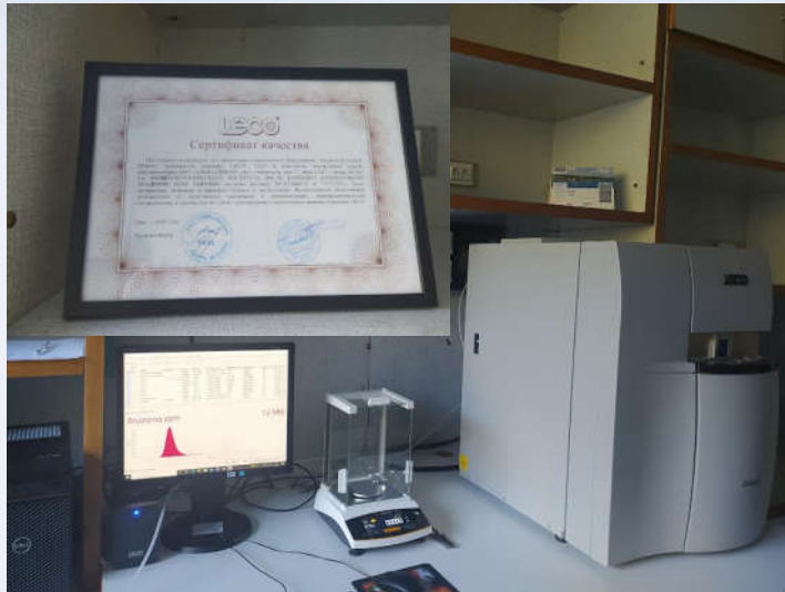
Аналізатор дифузійно-рухомого і залишкового водню LECO DH603
