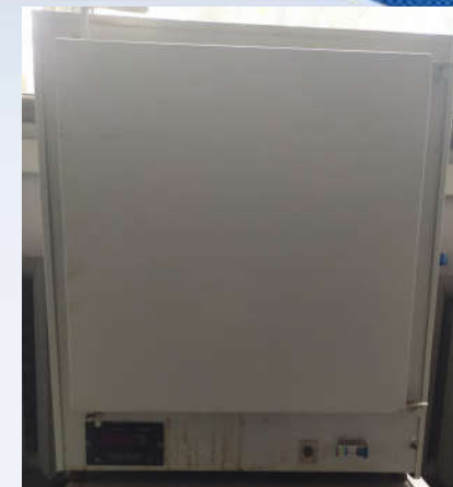
Печі для термічної обробки металів: СНОЛ 6,7/1300; СНОЛ 1,6.2,5,1/9-ИЗ та СНОЛ 0,35
