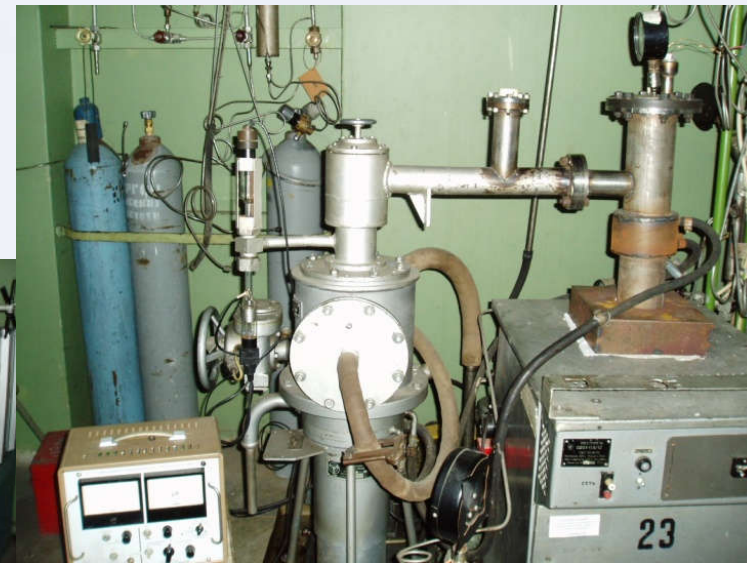
Установки для термічної обробки в вакуумі та контрольованих газових середовищах
